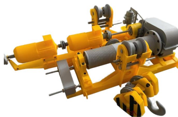
Рис.5. Модель тележки мостового крана для атомной промышленности.
