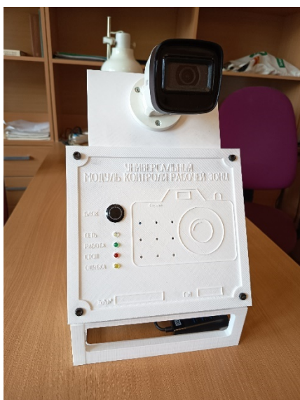
Рис.2. Универсальный модуль контроля рабочей зоны с компьютерным зрением и элементами искусственного интеллекта.
