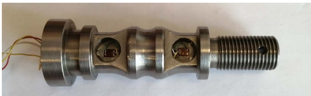
Рис. 3. Опытный образец разрабатываемой тензооси
