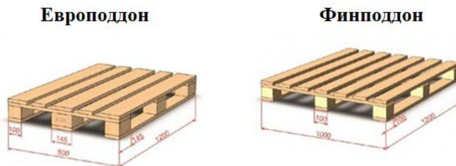
Рис. 7. Основные типы поддонов, используемые в РФ
