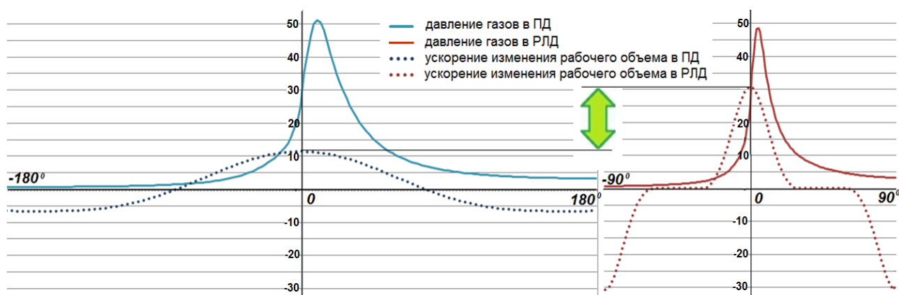
Рис. 6. Сравнение динамики процессов в ПД и РЛД (в условных единицах измерения) в зависимости от угла поворота выходного вала
