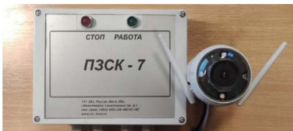
Рис. 3. Прибор защиты от столкновения кранов, работающих на одном рельсовом пути
