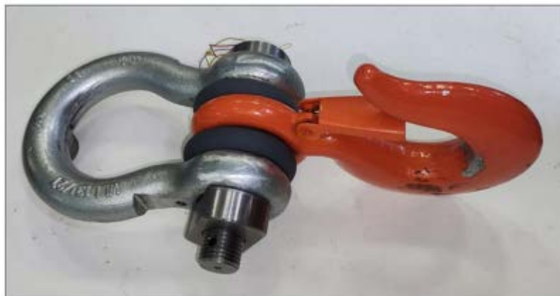
Рис. 1. Исполнение крановых весов с оригинальным исполнением тензооси
