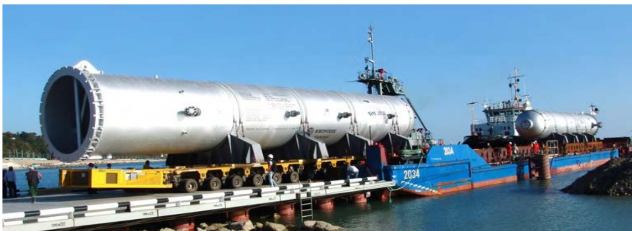
Рис. 6. Выгрузка негабаритного оборудования методом Ро-Ро при помощи тяжеловесных модульных транспортеров
