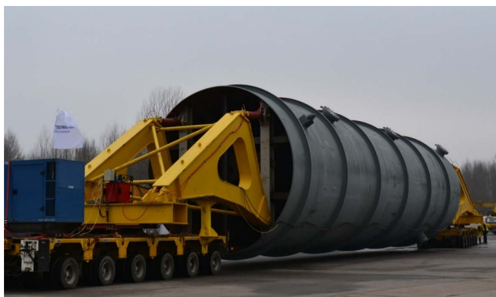
Рис. 4. Применение транспортных модулей для перевозки грузов в «провисе»
