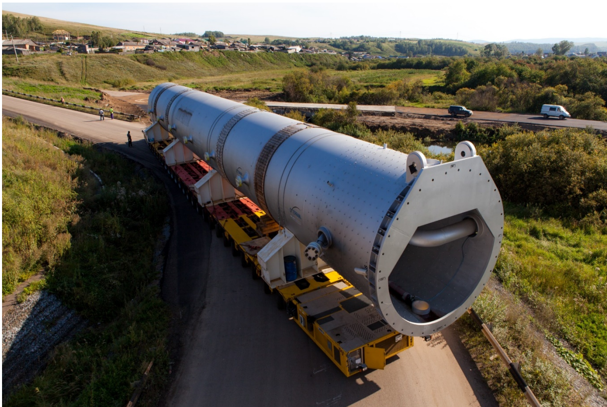
Рис. 2. Перевозка на самоходном модульном транспортере реактора гидрокрекинга весом 1306 т на расстояние 203 км из поселка Кубеково в город Ачинск Красноярского края для АО «Ачинский НПЗ ВНК» (2013 г)
