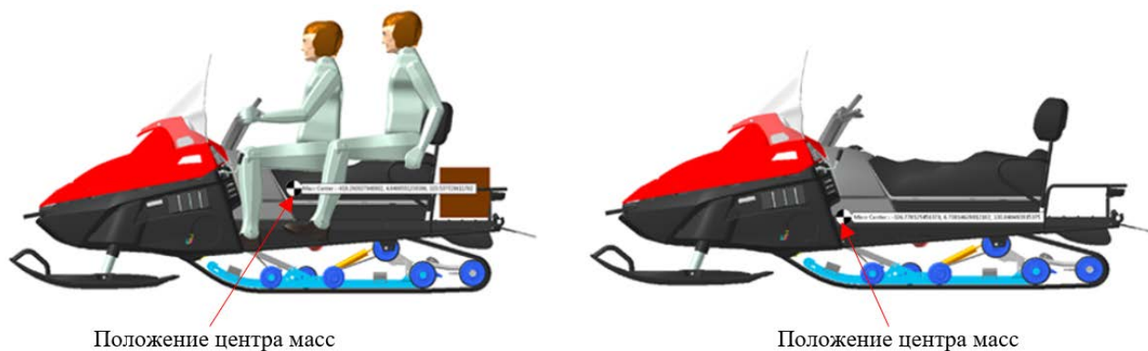
Рис. 3. Центр масс снегохода: а – с людьми и грузом, б – без людей и груза
