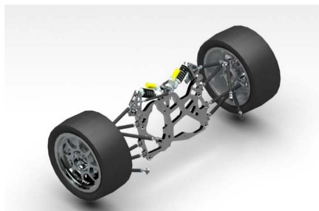
Рис. 4. Задняя система поддрессирования автомобиля “BRT-8D”
