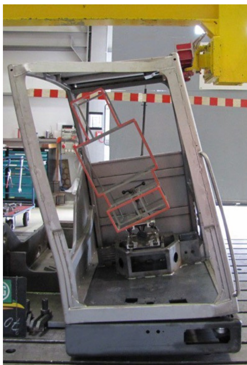
Рис. 1. Пример нагружения ROPS каркаса кабины боковой нагрузкой
