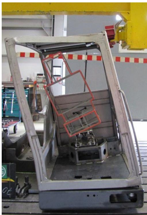
**Рис. 1.** Пример нагружения ROPS каркаса кабины боковой нагрузкой
