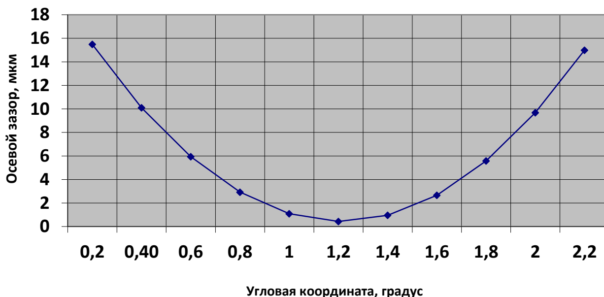
Рис. 10. Осевой зазор между витками винта и ролика по дуге окружности радиуса r \approx 24,05 мм
