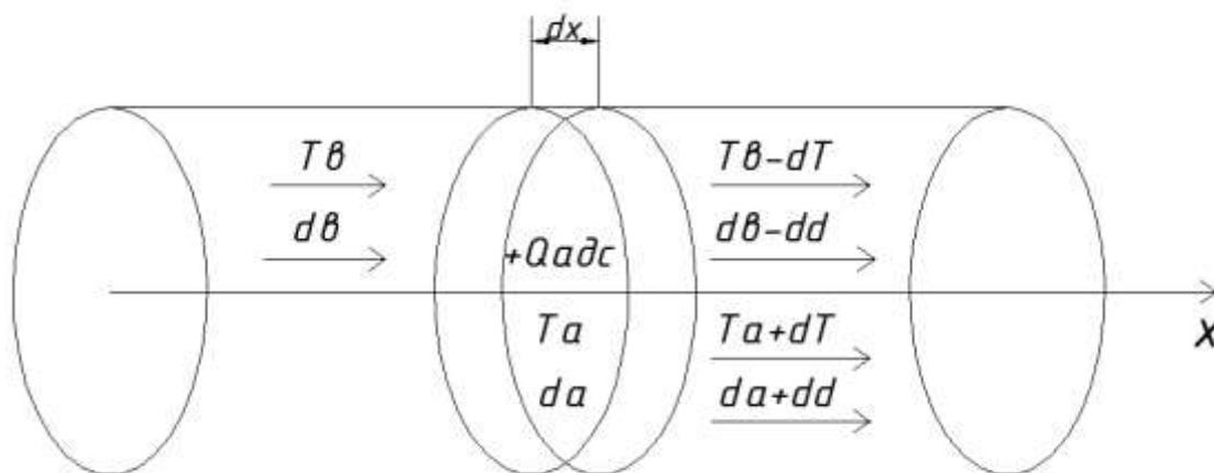
Рис. 2. Физическая модель динамики адсорбции в адсорбционной колонне.
