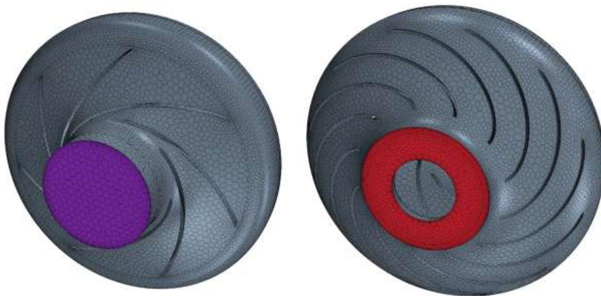
Рис. 3. Проточная часть первой ступени.
