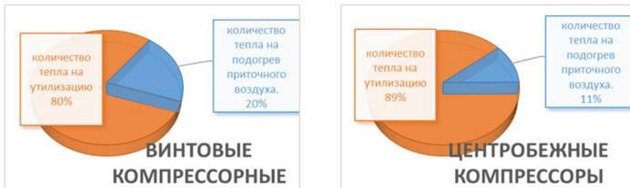
Рис. 5 Распределение тепловой энергии сжатия в винтовых и центробежных компрессорах.
