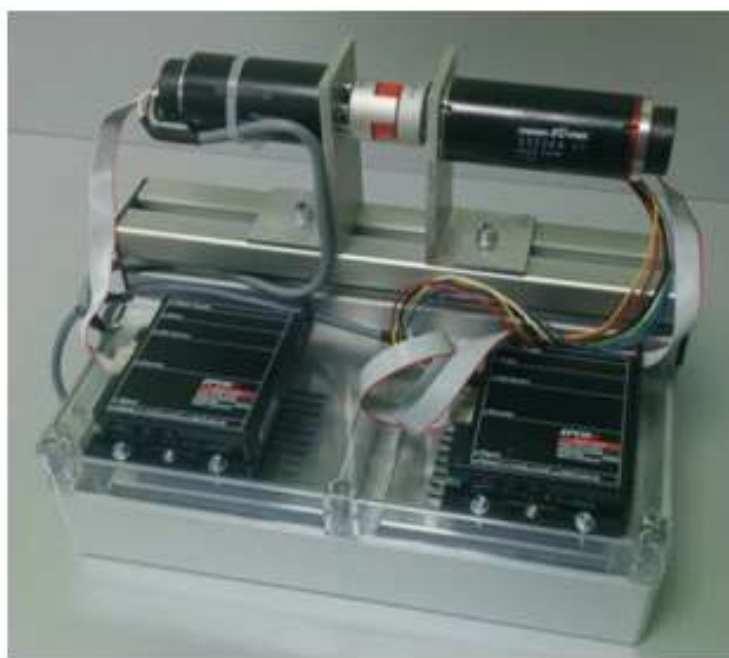
Рис. 1. Внешний вид стенда при согласованной работе приводов (электродвигатель тахон RE 40 – слева; электродвигатель тахон EC-max 40 – справа)
