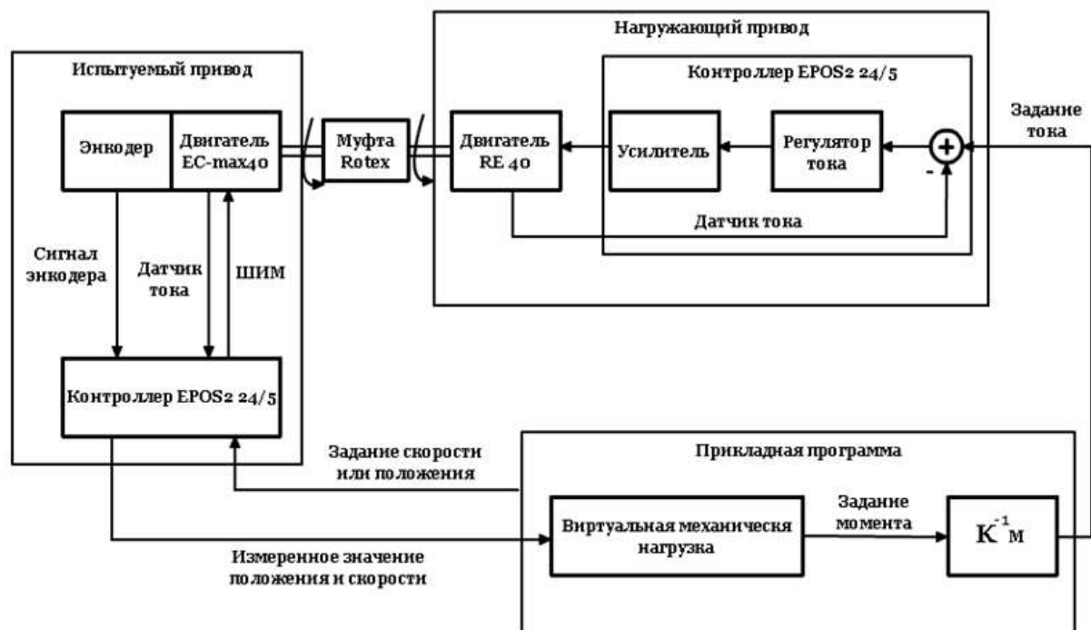
Рис. 2. Структурная схема стенда при согласованной работе электроприводов
