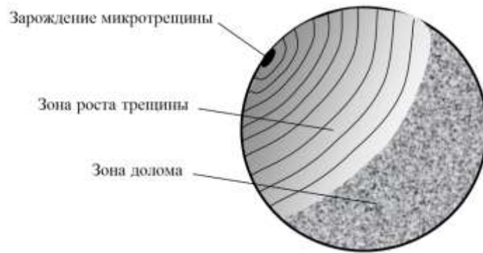
Рис. 4. Предполагаемый усталостный излом вала шпинделя в опасном сечении
