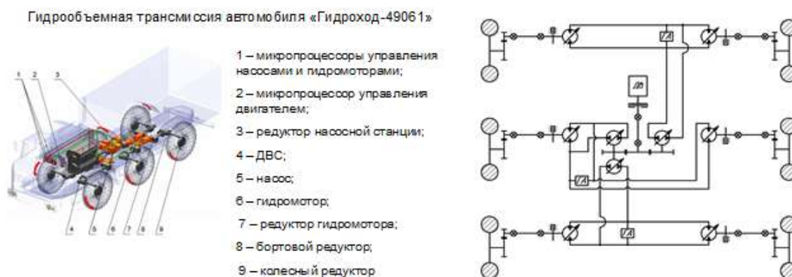
Рис. 2. Принципиальная схема ГОТ и ее компоновка на автомобиле «Гидроход-49061» [1]:
