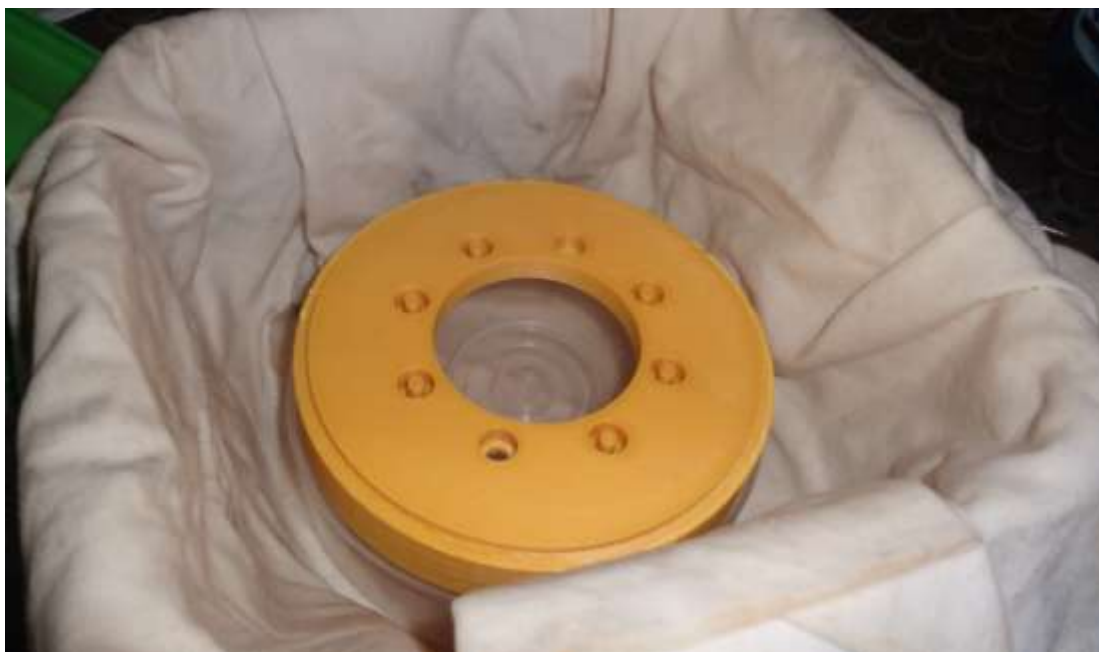
Рис. 6. Поверхностное упрочнение изделия в парах ацетона
