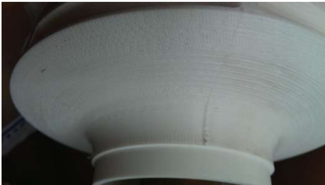
Рис. 3. Структура поверхности рабочего колеса, изготовленного методом экструзивного 3D-прототипирования
