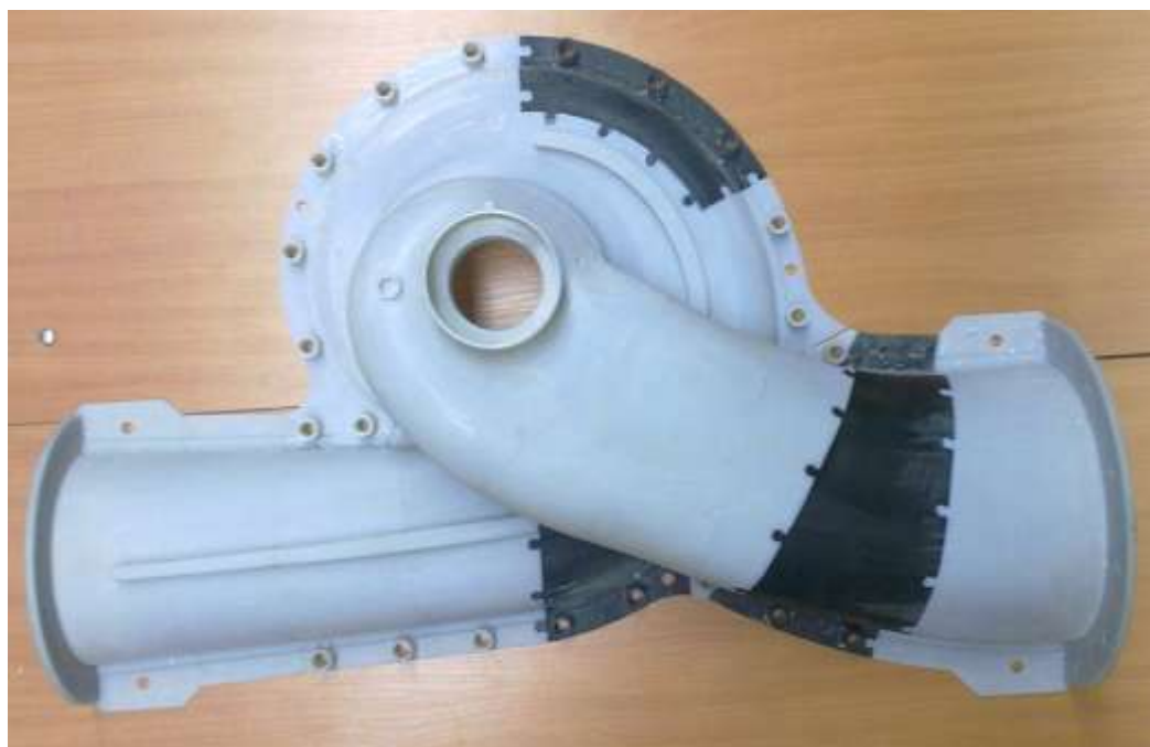
Рис. 2. Изготовленная на 3-D принтере оболочечная сборная модель проточной части насоса
