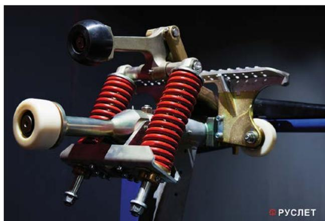
**Рис. 3.** Отцепляемый зажим для однокольцевых пассажирских канатных дорог
