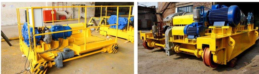
**Рис. 2.** Тележки мостового крана ООО «ОКТ» [12], ООО «Еврокран» [13].
