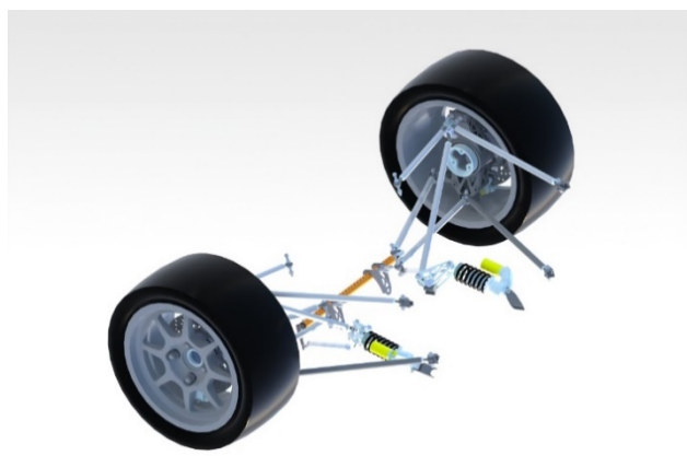
Рис. 3. Задняя система поддрессирования автомобиля “BRT-7”
